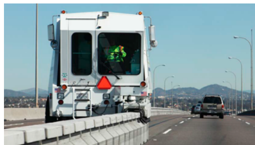
Reversible Managed Lanes (Carriles Administrados Reversibles) Un carril exprés que puede cambiar la dirección del tráfico dependiendo de la hora del día o de las condiciones del tráfico.
